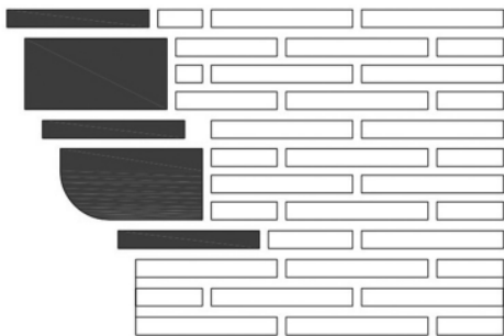
Figura 15 Dibujo del aparejo y alero del ejemplo de las figuras 13 y 14 (Basterra 2017)
