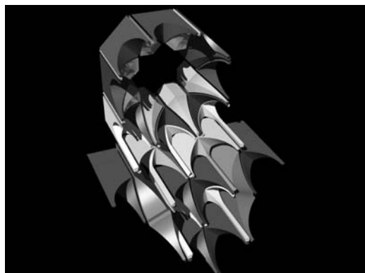
Figura 15 Reconstrucción volumétrica que muestra el montaje de la bóveda de mocárabes de la mezquita Ben Joussef en Marrakech, el dibujo muestra en detalle el arranque de la bóveda (dibujo del autor)
