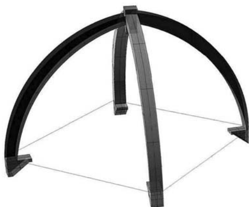
Figura 5 Estructura de ojivos apuntados de la bóveda de Salamanca
