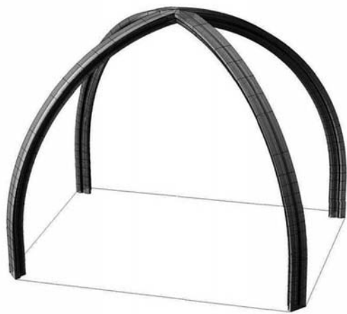
Figura 6 Estructura de ojivos apuntados de la bóveda de Zamora
