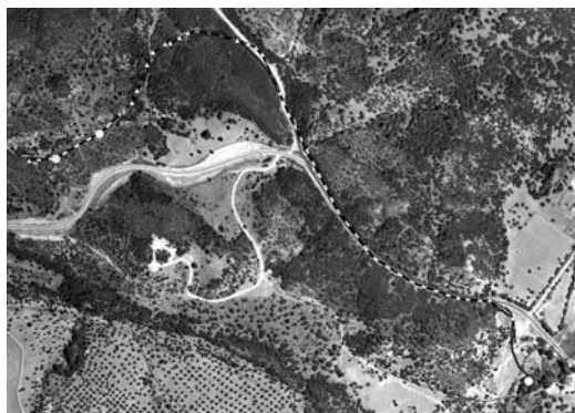
Figura 4 Procedimiento de ajuste de la hipótesis de trazado, tramo Tempul - arroyo del Bollo
