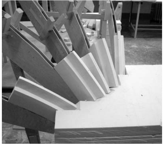
Figura 10 La bóveda propiamente dicha comienza cuando acaba el jarjamento
