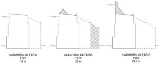
Figura 7 Evolución de los refuerzos y recrecidos del perfil de la presa extremeña de Albuhera de Feria
