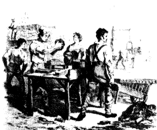
Figura 1 Producción artesanal de ladrillos ( tamargos o tejeros ), que coexistió en Asturias con la mecanizada durante todo el periodo estudiado, especialmente en zonas rurales periféricas, alejadas de las principales fábricas y carentes de buenas comunicaciones, Grabado inglés publicado por Cunningham (véase bibliografía)
