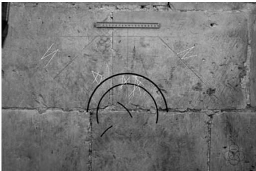
Figuras 5 y 6 Vista general de la montea y detalle de la misma (Alonso Ruiz, 2013)
