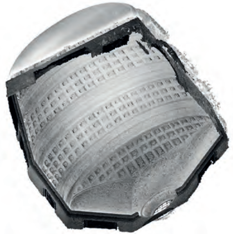
Figura 2 Nube de puntos tridimensional de la bóveda, vista desde abajo hacia arriba
